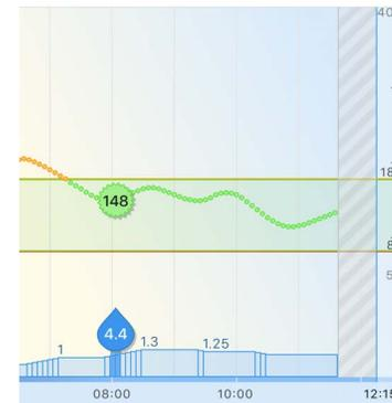
Sie sehen auch einen grau schattierten Bereich im Diagramm, da keine Daten angezeigt werden können, wenn die Verbindung unterbrochen wird. Wenn die Verbindung unterbrochen ist, verwenden Sie die Pumpe, um eine Therapie zu verabreichen, während Sie den Verlust der Verbindung beheben.
