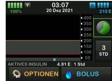
Am Ende der zweistündigen Aufwärmphase wird das Countdown-Symbol durch den aktuellen CGM-Wert ersetzt.
