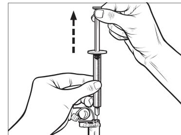
5. Belassen Sie die Nadel in der Einfüllöffnung und lassen Sie den Spritzenkolben los. Durch den vorhandenen Unterdruck bewegt sich der Spritzenkolben in seine Neutralposition, es wird jedoch
