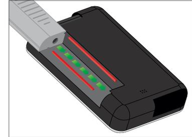
8. Drücken Sie auf die runde Einfüllöffnung neben dem Reservoirschlauch, um das Reservoir auf die Pumpe zu schieben. Tippen Sie anschließend auf das **ENTSPERREN**-Symbol.
