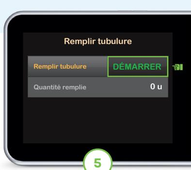
Maintenez la pompe et la tubulure à la verticale pour vous assurer que l'air éventuellement présent dans le réservoir soit d'abord expulsé. Touchez **DÉMARRER**. La pompe émettra un signal sonore ou vibrera régulièrement pendant le remplissage de la tubulure.
